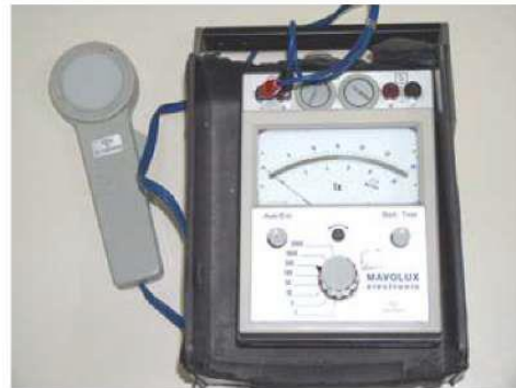
Σχήμα 5. Φωτόμετρο, συσκευή μέτρησης αναλογικού χαρακτήρα.
