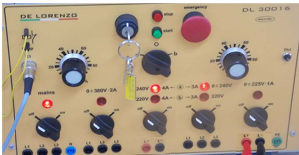
Εικόνα 9.2: Μονάδα DL 30016 (τροφοδοτικό DC)
