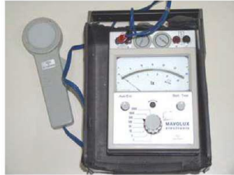
Σχήμα 5. Φωτόμετρο, συσκευή μέτρησης αναλογικού χαρακτήρα.
