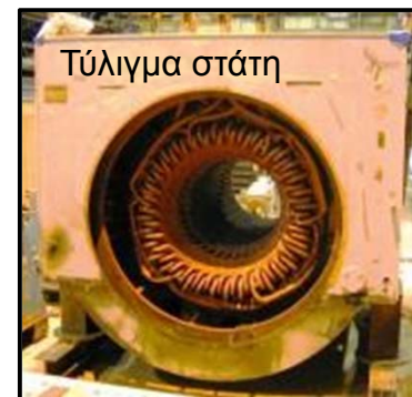
Τυπικό τύλιγμα στάτη γεννήτριας Ε.Ρ. ( General Electric )
