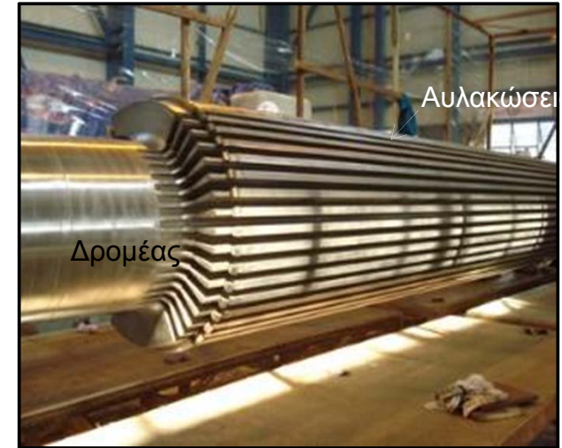
Αυλακώσεις σε δρομέα σύγχρονης γεννήτριας Ε.Ρ. cr4.globalspec.com
