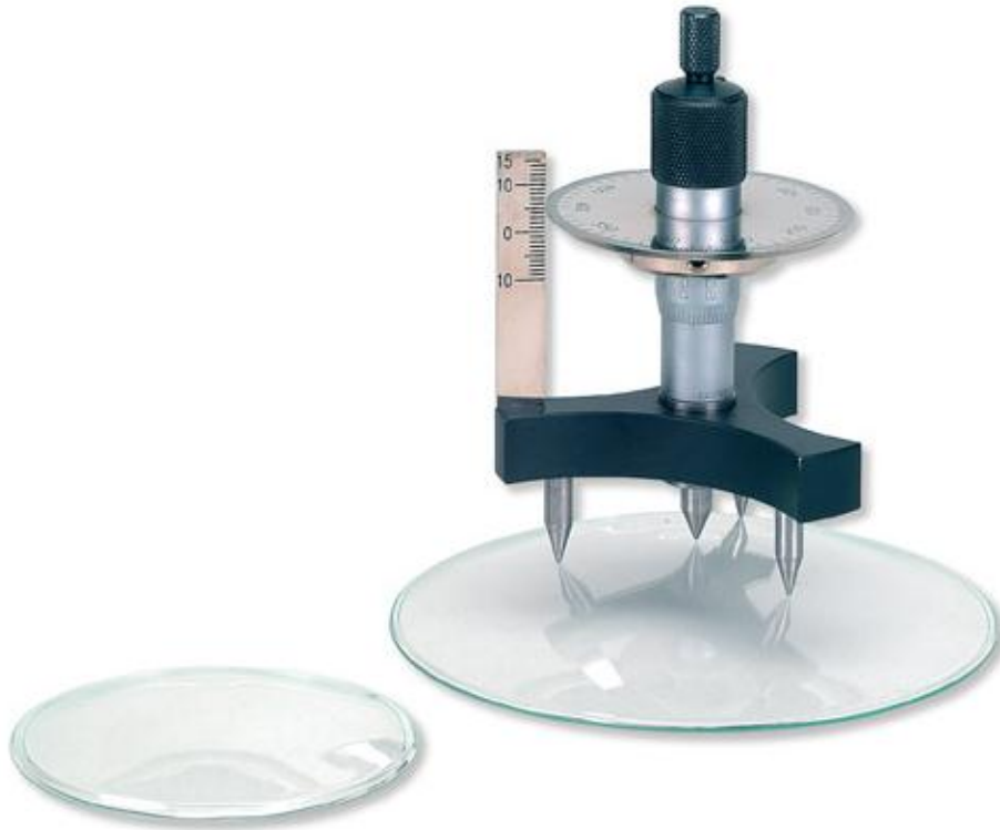
Σχήμα 7. Σφαιρόμετρο, κύρια χαρακτηριστικά, η τοποθέτησή του κατά την διαδικασία της μέτρησης.
